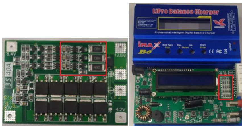
Рис. 1. Пассивный баланси́р в плате BMS и зарядное устройство с встроенным баланси́ром
