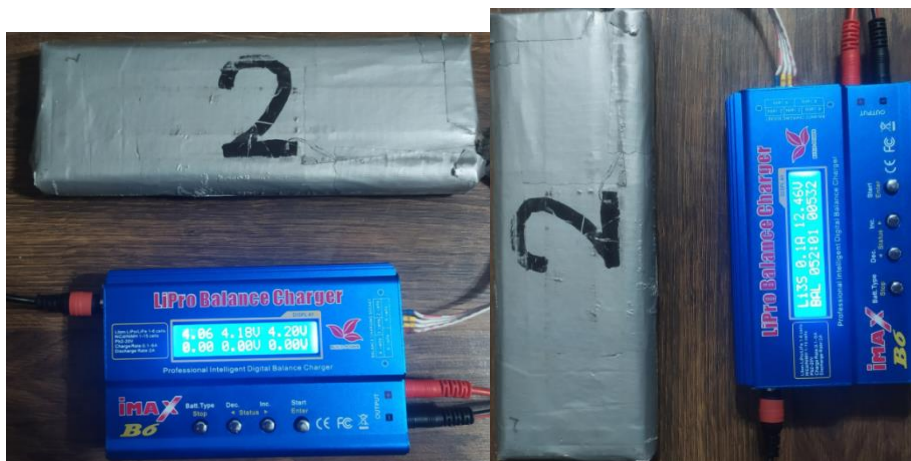
Рис. 3. Замедлившаяся зарядка после третьей ячейки аккумулятора
