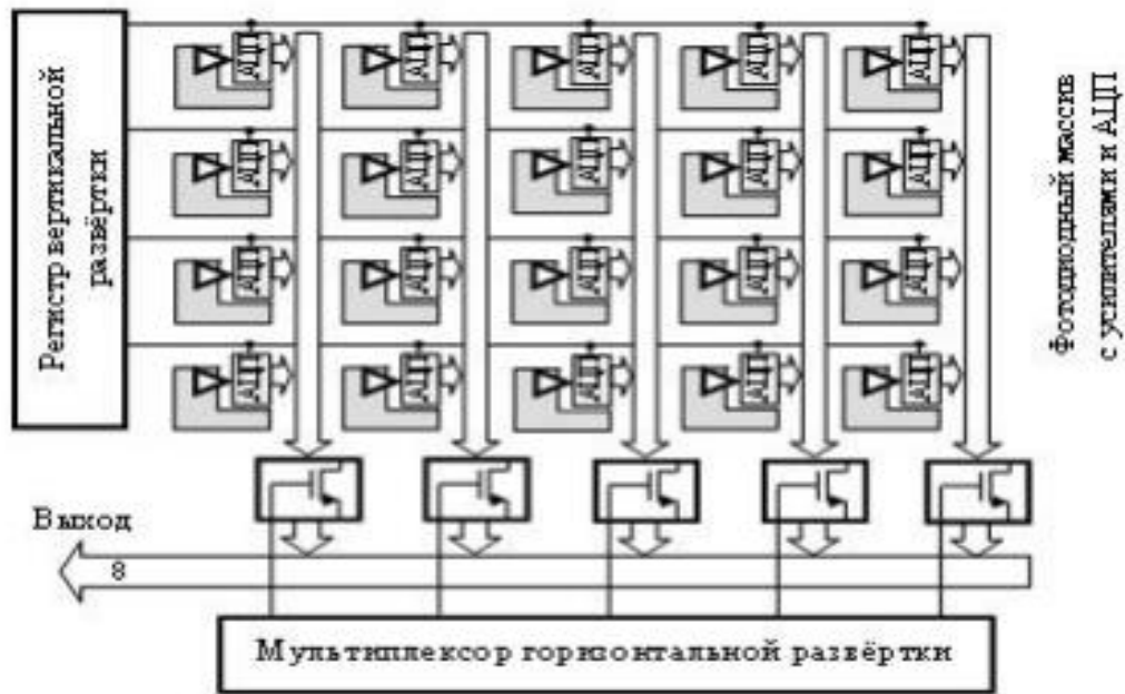
Рис. 3. КМОП-сенсор с цифровым пикселем
