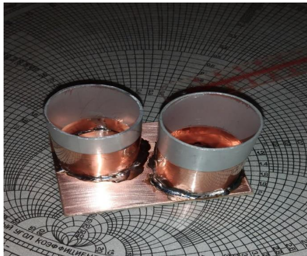
Рис. 5. Масштабный макет облучателя
