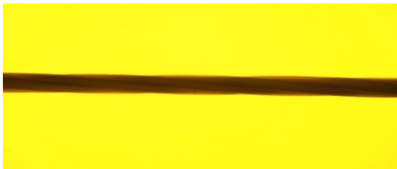
Рис. 3. Изображение продольного сечения микроструктурированного волокна с 6 сердцевинами.
